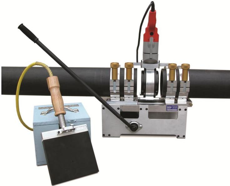
Компактная система для стыковой сварки, предназначена для сплавления ПЭ и HDPE трубы от 25 мм до 152 мм в диаметре, что делает ее идеальным инструментом для выполнения многих работ. Машина при работе использует инструмент, расположенный между хомутами направляющей втулки.
