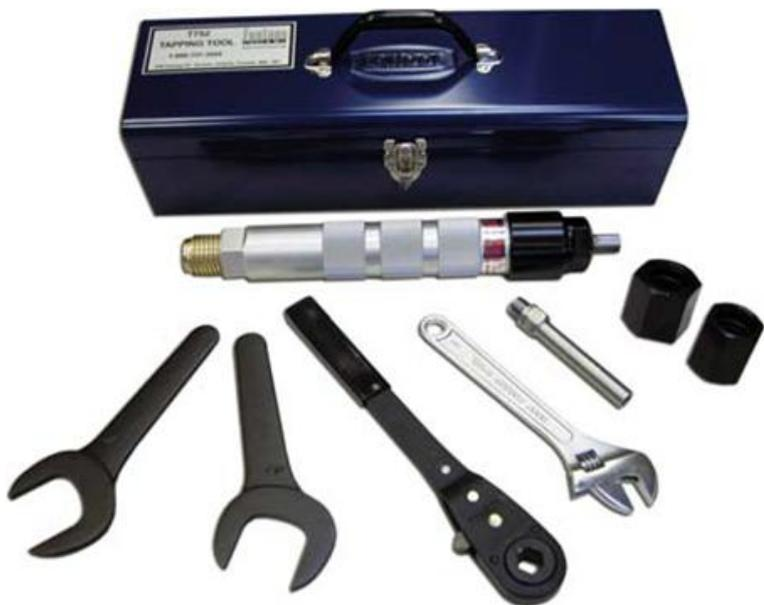
Идеальный инструмент для врезки под давлением в трубопроводы (водопроводы, газопроводы, нефтепроводы) без отключения потребителей.
