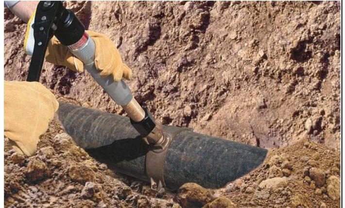
Идеальный инструмент для врезки под давлением в трубопроводы (водопроводы, газопроводы, нефтепроводы) без отключения потребителей.
