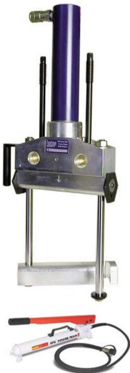
Этот инструмент разработан специально для безопасного и эффективного сжатия пластиковых труб средней и высокой жесткости диаметром от 25 до 100 мм.
